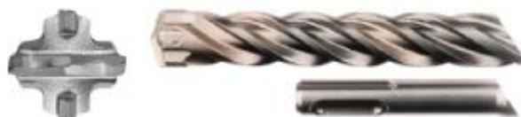
Broca Nemesis II para taladrar hormigón. La broca es adecuada para máquinas SDS-PLUS y es especial para usuarios que perforan con frecuencia en hormigón armado. La punta de centrado y la punta maciza de carburo de tungsteno de 4 filos garantizan una perforación precisa, óptima y rápida. Esta broca tiene una longitud total de 450 mm, una longitud de trabajo de 400 mm y un diámetro de 24 mm.
