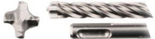
Fresa Nemesis II para taladrar hormigón. La broca es adecuada para máquinas SDS-PLUS y es especialmente adecuada para usuarios que perforan con frecuencia en hormigón armado. La punta de centrado y la punta de carburo de tungsteno 4 cortador sólido asegura una perforación precisa, óptima y rápida. Esta broca tiene una longitud total de 165 mm, una longitud de trabajo de 100 mm y un diámetro de 8 mm.
