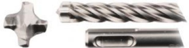
Fresa Nemesis II para taladrar hormigón. La broca es adecuada para máquinas SDS-PLUS y es especialmente adecuada para usuarios que perforan con frecuencia en hormigón armado. La punta de centrado y la punta de carburo de tungsteno 4 cortador sólido asegura una perforación precisa, óptima y rápida. Esta broca tiene una longitud total de 115 mm, una longitud de trabajo de 50 mm y un diámetro de 6 mm.
