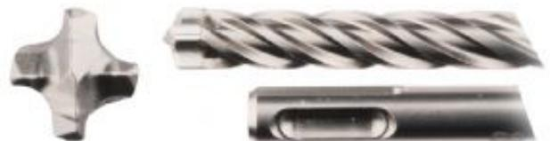
Fresa Nemesis II para taladrar hormigón. La broca es adecuada para máquinas SDS-PLUS y es especialmente adecuada para usuarios que perforan con frecuencia en hormigón armado. La punta de centrado y la punta de carburo de tungsteno 4 cortador sólido asegura una perforación precisa, óptima y rápida. Esta broca tiene una longitud total de 115 mm, una longitud de trabajo de 50 mm y un diámetro de 5 mm.
