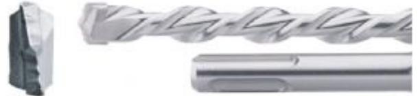
Broca de martillo SDS-PLUS para taladrar hormigón. La hoja de doble filo permite una perforación rápida. La punta de carburo de tungsteno aumenta la eficacia del trabajo. Esta broca tiene una longitud total de 110 mm, una longitud de trabajo de 50 mm y un diámetro de 8 mm.
