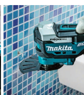
Encaje de juntas en revestimiento cerámico.
