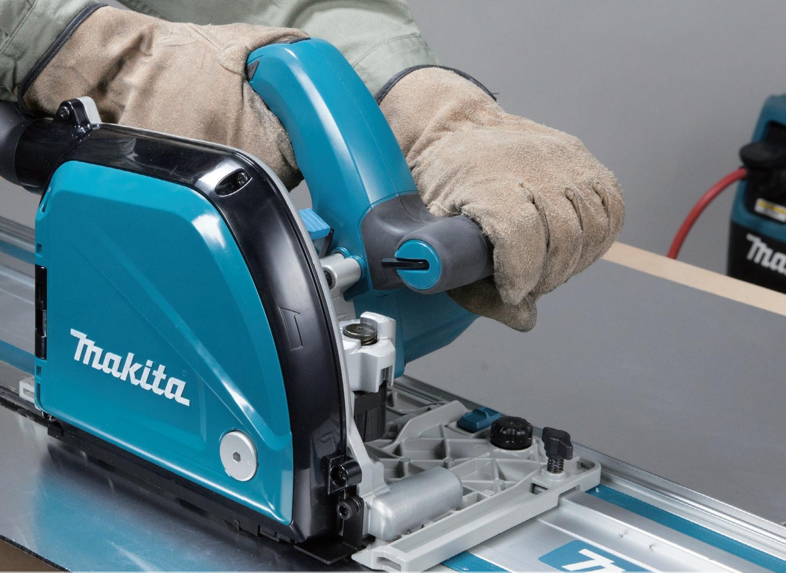
Fresados en V de composites con láminas de aluminio.
