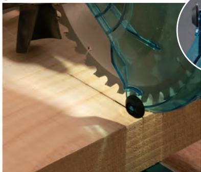
La luz de trabajo LED proyecta una sombra de la hoja de sierra sobre la pieza de trabajo creando una línea de corte exacta. Alineando la sombra con la línea de marcada en la pieza de trabajo, puede realizar un corte exacto.
