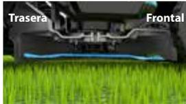
La hoja está diseñada para que se incline hacia la parte delantera del cortacésped cuando está acoplada, lo que evita el doble corte y reduce el consumo de corriente.
