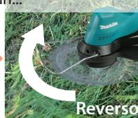
A través de su botón de modo "reverso" la máquina efectuará un cambio de sentido durante 1,5 segundos para la extraer hierbas atascadas, y automáticamente volverá su giro normal.
